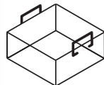
Griffe seitlich außen am Korb Handles on the outside of the basket
